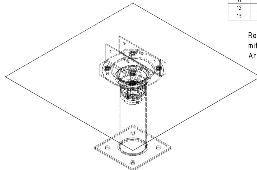
Roof-PIN Aufständerung für Montage auf Beton
